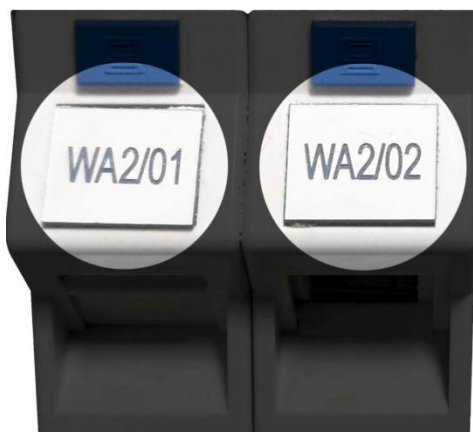
Rysunek 16 Oznaczenie Punktów Logicznych za pomocą etykiet
